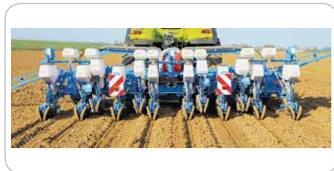
Telaio ripiegabile flottante MISTO mt. 6,00 - ingombro mt. 3,20
