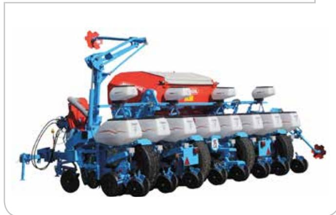
Il telaio trainato ripieghevole Wing-Fold può ricevere 6-8 elementi seminatori in versione "mais". Come i telai trainati rigidi, essi sono equipaggiati in standard in blocchi ruote idraulici. Il ripiegamento delle ali si effettua sull'avanti per un trasporto su strada facilitato. Questo telaio può essere equipaggiato di un fertilizzatore "Grande Capacità" di 1500 litri su 8 file, 1000 lt su 6 file. Timone articolato - cardano doppio omocinetico.
